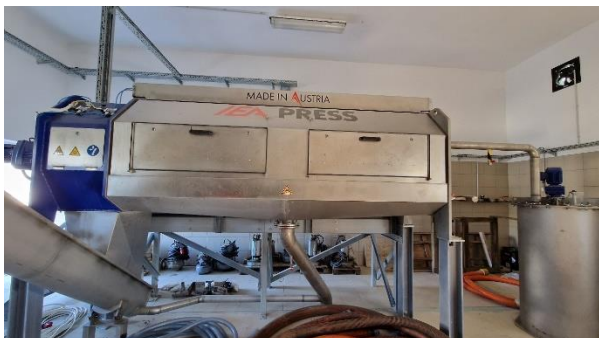
23. kép: Iszapvíztelenítő csigas prés
