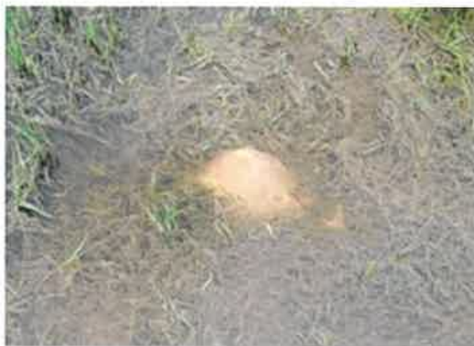
1. sz. kép: Alacsony vízhozamú törpebuzgár
